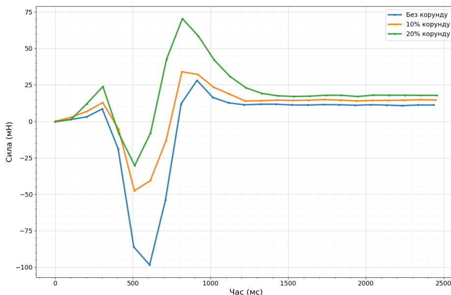
Рис. 5. Зміни значення сили для чистого силіконового мастила та КДС з 10% і 20% вмістом корунду
