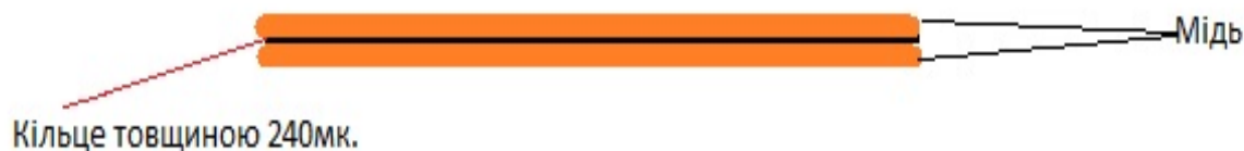
Рис. 4. Схема виготовлення дослідних зразків Cu-Sn.
