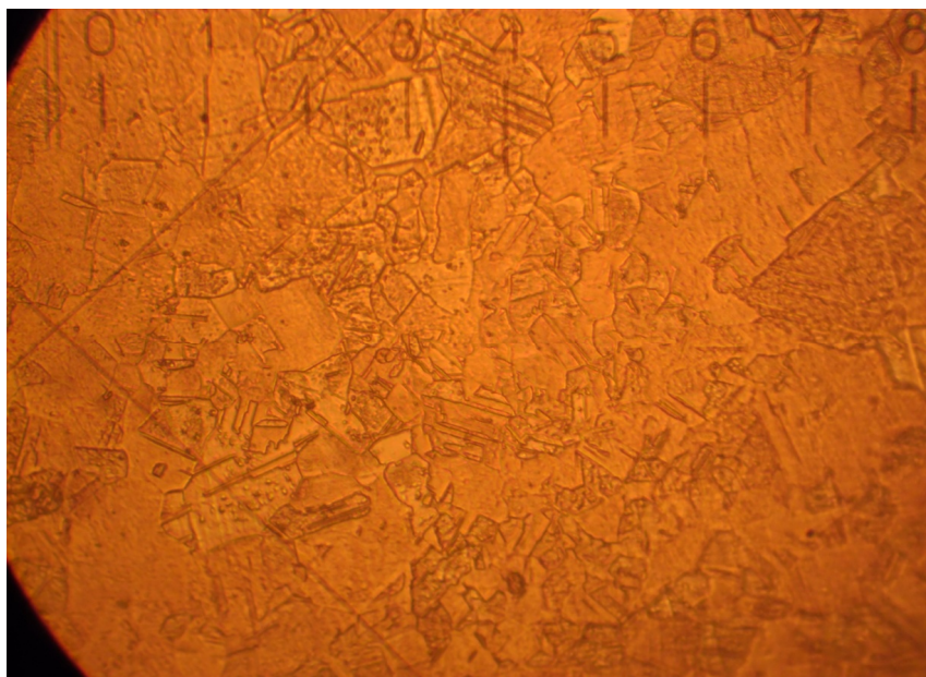
Рис. 1. Мікроструктура міді після відпалу при температурі 400 0 С протягом 1 год 40 хв. Збільшення 488х.
